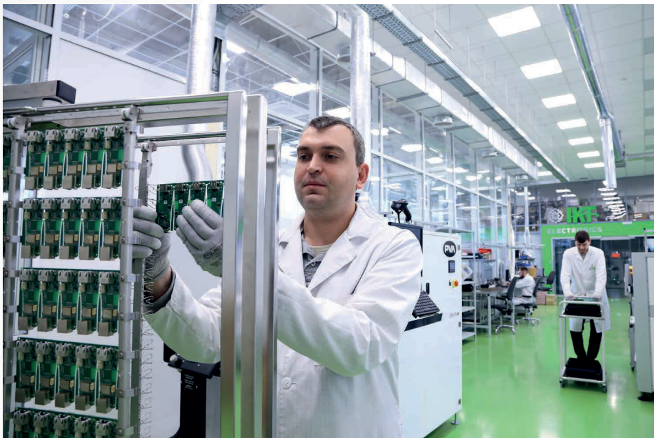
Автоматизированная система отмывки печатных узлов от остатков флюса SuperSWASH III
