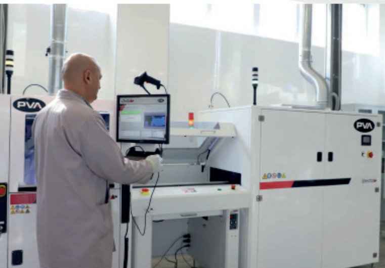
Система ультрафиолетовой полимеризации влагозащитных материалов, клеев и компаундов PVA SPECTRA.
